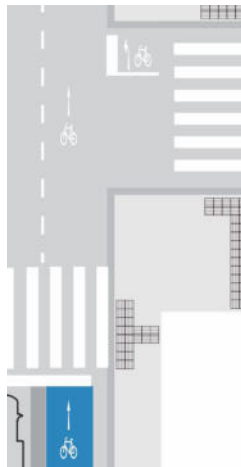
Beispiel einer Aufstellfläche zum Queren
