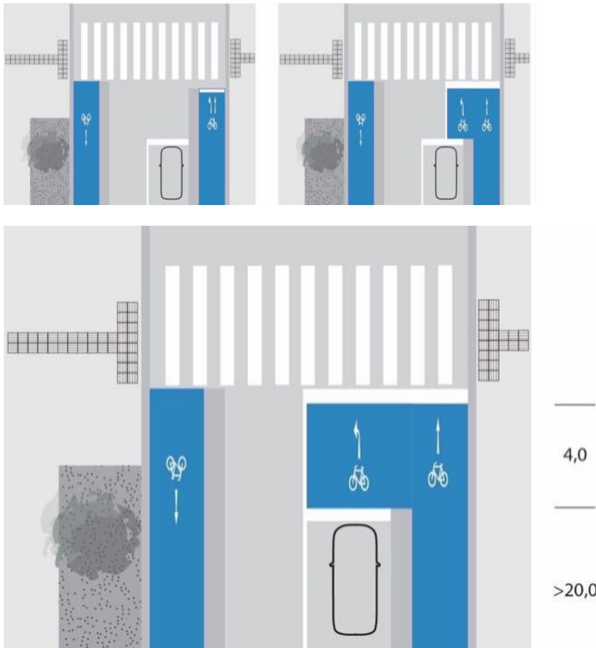
Varianten von vorgezogener Haltelinie bei (geschütztem) Radfahrstreifen.
