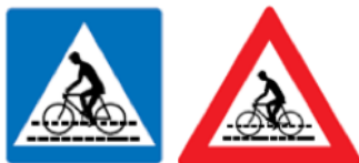
Verkehrszeichen bei einer Radüberfahrt und Anzeige einer nähernden Radüberfahrt
