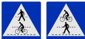
Schutzweg und Radfahrerüberfahrt kombiniert
